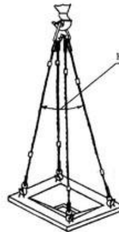
Строп 4СК1-3,2+4СК1-10,0 Q=3,2÷10,0 тс при монтаже
