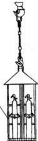
Строп 1СК-2,5 Q=2,5 тс при подаче контейнера для хранения баллонов Р=750 кг
