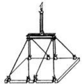
Траверса Т-1 Q=8,0 тс при монтаже плит
