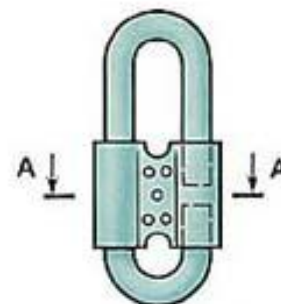
"Pов" - с замком грузоподъемность до 2 т
