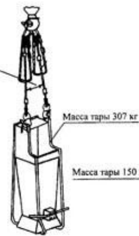
Строп 4СК1-10,0 Q=10,0 тс при подаче бункера(баллы) с бетонной смесью V=1 м 3 Р=3,0 т
