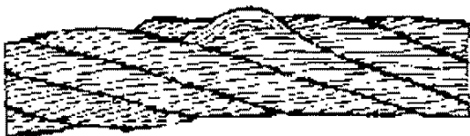
в) выдавливание проволок в одной пряди
