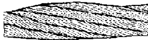
д) местное увеличение диаметра каната
