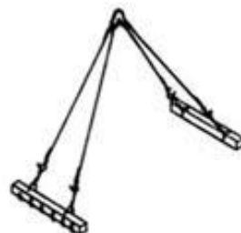
Траверса для подъема карт из профнастила
