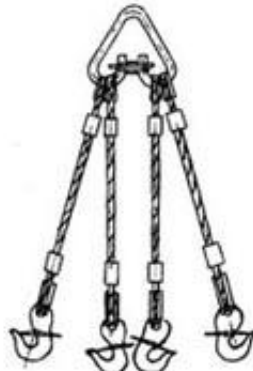
Строп канатный четырех- ветвевой типа 4 СК1 ГОСТ 25573-82*
