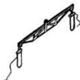
Траверса универсальная для подъема ферм, балок
