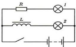
Явление возникновения ЭДС индукции в электрической цепи в результате изменения силы тока в цепи называется самоиндукцией.  $\Phi \sim I$ , то  $\Phi = LI$ ,  $L$  — коэффициент пропорциональности между током в
