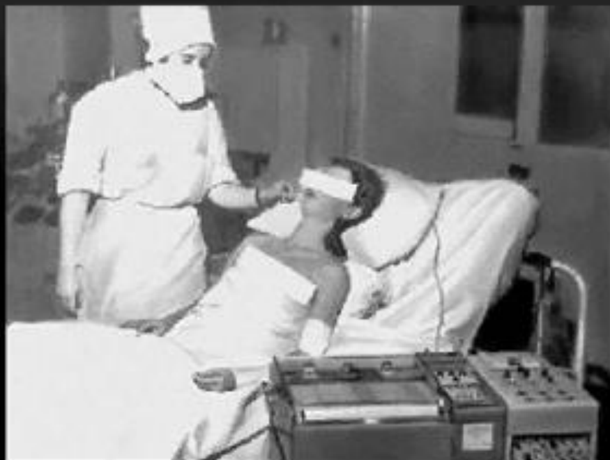
Применение масс-спектрометрического газоанализатора MX-6202 для анализа выдыхаемого газа
